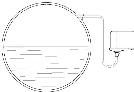
L'apparecchio può essere montato in qualsiasi posizione, tuttavia si consiglia la sistemazione con l'asse verticale e con presa di pressione come da schema illustrativo. Ciò per evitare che i depositi che si formano vadano ad ostruire il condotto della pressione.
